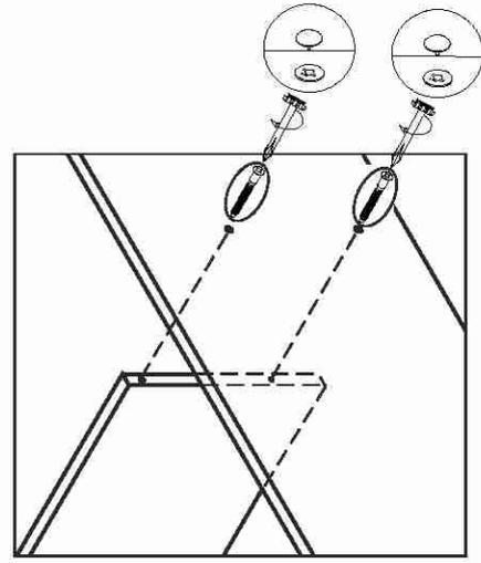
Отверстия диаметром 5 мм рассверлить сверлом диаметром 5 мм до сквозных.
