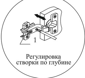
Регулировка створки по глубине
